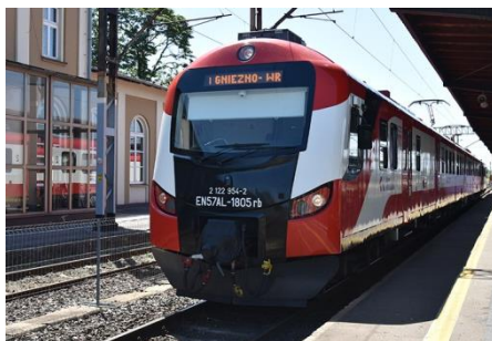
EN57AL – 5 pojazdów Miejsca siedzące /stojące – 168 /249 Prędkość maksymalna– 120 km/h
