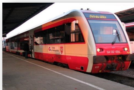
SA 132 – 11 pojazdów Miejsca siedzące / stojące – 164 /140 Prędkość maksymalna – 120 km/h
