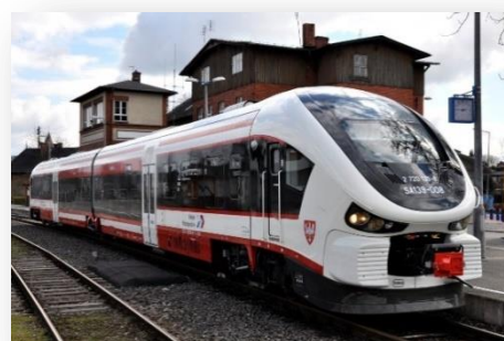
SA 139 – 2 pojazdy Miejsca siedzące/stojące -126/80 Prędkość maksymalna – 120 km/h
