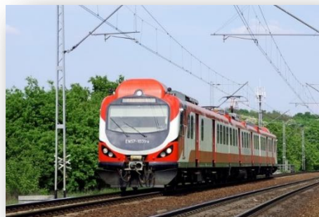
EN 57Akw – 7 pojazdów Miejsca siedzące /stojące – 180/170 Prędkość maksymalna– 120 km/h
