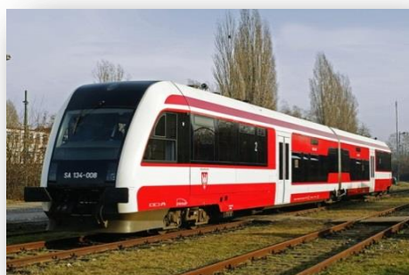
SA 134 – 4 pojazdy Miejsca siedzące/stojące – 138 /140 Prędkość maksymalna – 120 km/h
