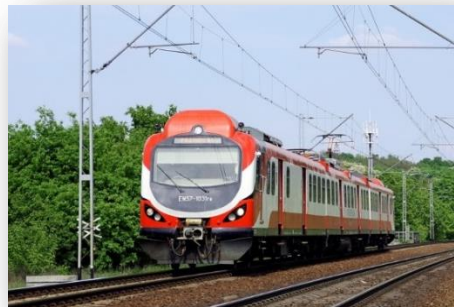
EN 57Akw – 4 pojazdów Miejsca siedzące / stojące – 180/170 Prędkość maksymalna– 120 km/h
