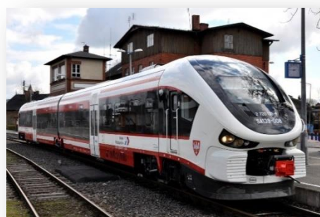
SA 139 – 4 pojazdy Miejsca siedzące/stojące -126/80 Prędkość maksymalna – 120 km/h
