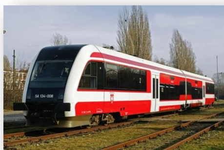
SA 134 – 2 pojazdy Miejsca siedzące/stojące – 138 /140 Prędkość maksymalna – 120 km/h
