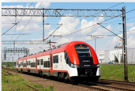
EN 76 – ELF – 22 pojazdy Miejsca siedzące / stojące – 204 /246 Prędkość maksymalna– 160 km/h
